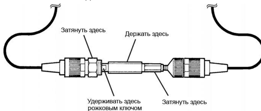
Рисунок 3-10 Затяжка соединений
