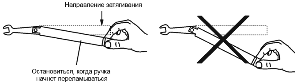
Рисунок 3-7 Использование динамометрического ключа
